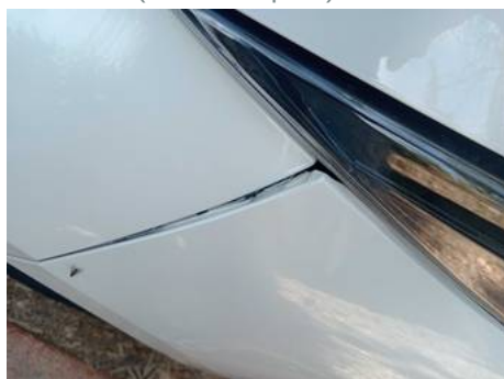
Bouclier avant (Défaut aspect)
